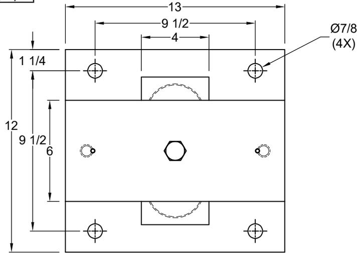
MODEL M2SSHX-1E SEISMICALLY RESTRAINED VIBRATION ISOLATOR FOR 1" DEFLECTION
